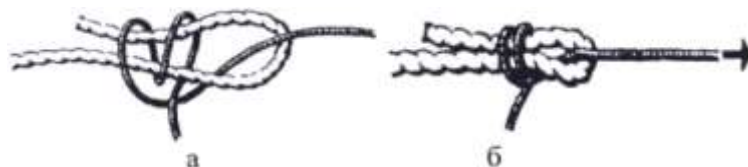
Рис. 23. Брамшкотовий вузол: а – в'язання вузла, б – навантажений вузол
