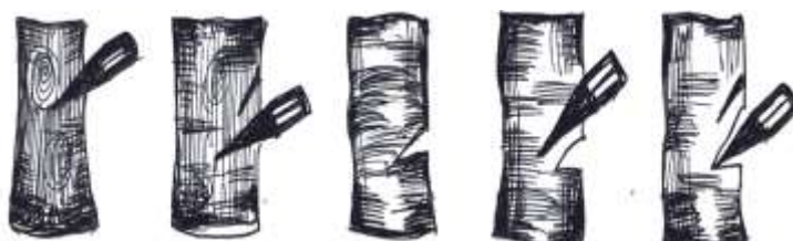
Рис. 10. Правильне завдання ударів сокирою під час рубання дерев
